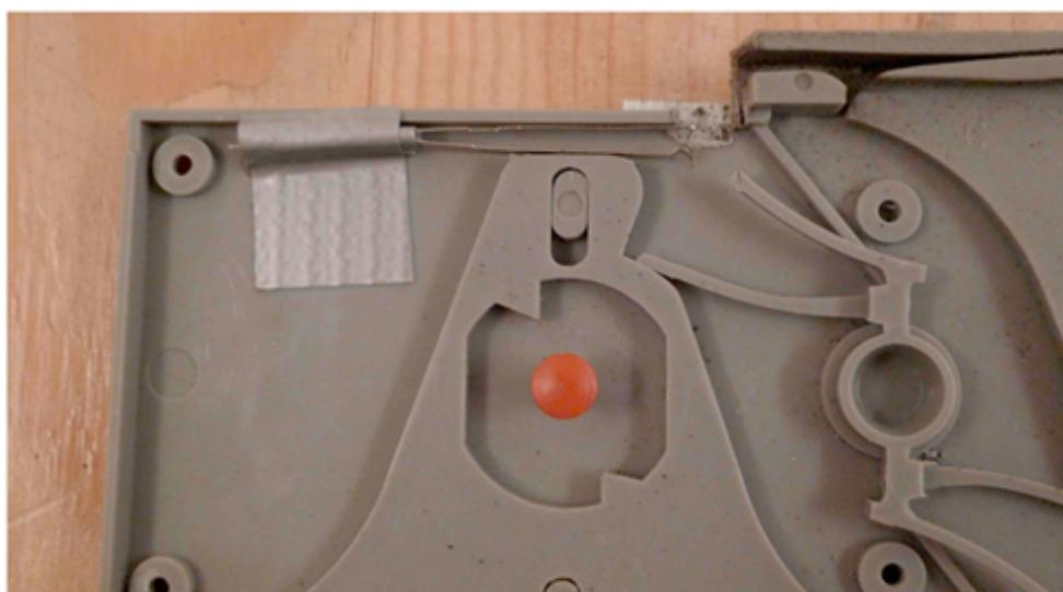
Démontage de l'élément Circuit 24 pour adaptation des lamelles sur le châssis du mécanisme. La fixation des lamelles est réalisée avec du scotch US sur le plastique du mécanisme. Les lamelles sont positionnées de manière à être
