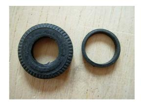
Encoller la partie non découpée (plus plane) du tambour avec une bonne colle (j'ai personnellement utilisé de la super glue). Si quelqu'un trouve une colle plus malléable qui supporte les torsions...
