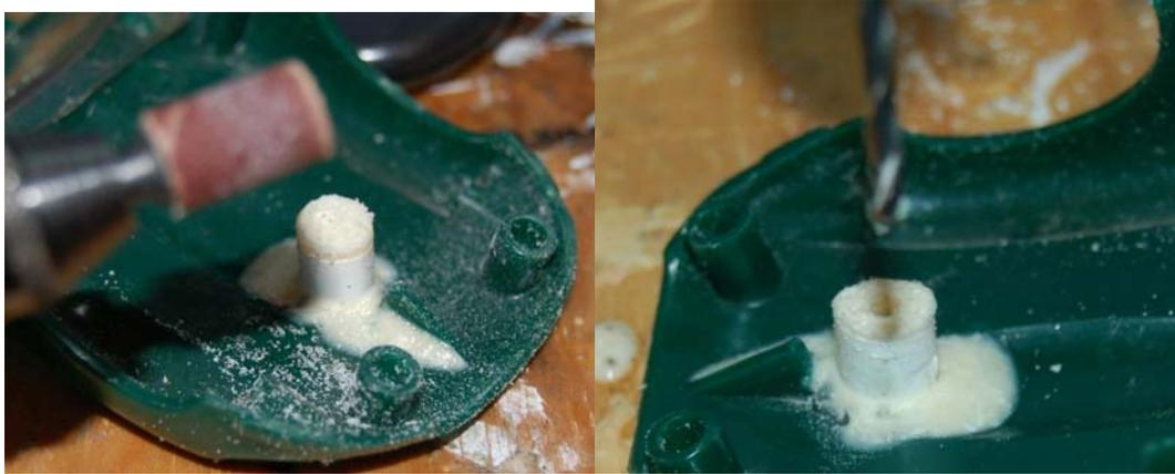
Je vérifie que la vis se positionne bien (figure 7) et éventuellement ajuste à nouveau avec la mèche. Un petit coup de peinture et le puits de vis est opérationnel (figure 8) !
