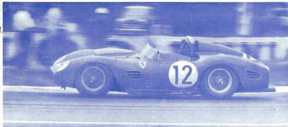
3 -- FERRARI 1959 - Poids-859 kg - Vitesse maximum de pointe : 292 km/h - Cylindrée : 2 953 cmc - Puissance à plein régime : 240 CV.
