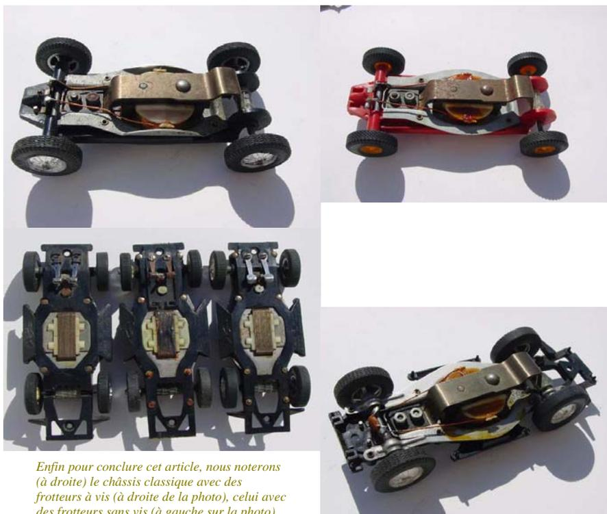
Enfin pour conclure cet article, nous noterons (à droite) le châssis classique avec des frotteurs à vis (à droite de la photo), celui avec des frotteurs sans vis (à gauche sur la photo) qui s'enclipsent comme les Karts et certains modèles de 1962 vite arrêtés car la chaleur faisait fondre le plastique autour du frotteur.
