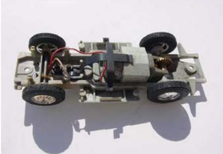
*Une version plus élaborée et sans charbons verra le jour plus tard pour équiper l'Interpiste (ci-dessus), le moteur "S" V2. Equipée d'une petite diode ce moteur fonctionne également sur le transformateur 24V alternatif.*
