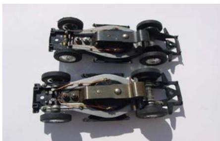
*Le moteur "S" (ci-dessous) avec des grosses résistances pour l'antiparasitage et un pont à diode pour permettre l'utilisation de ce moteur 12V continu sur le transformateur 24V alternatif. Particularité fonctionne avec des charbons extractibles. Si vous trouvez des charbons en pièces détachées prenez les, ils vous permettront de faire rouler avec plaisir ces modèles "silencieux" qui bien réglés sont très performants.*
