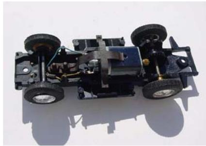
*La motorisation Bülher 12 V continu (ci-dessus) apparaît en 1971 sur les Porsche 917 K et Matra MS 650. Le moteur est fiable et performant. Certaines voitures sont équipées d'une diode pour le fonctionnement alternatif. Vers la fin de la commercialisation, cette motorisation équipa également des Ford GT 40, Jaguar Type E...Défaut des deux motorisations précédentes, le réglage par rapport à la couronne qui souvent peut faire des "soubresauts"*
