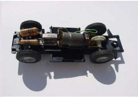
*Cette motorisation (dessus à gauche) a également été prévue en version "slot" sans pont à diode pour fonctionner en 12V continu avec le transformateur du Tiercé 24.*
