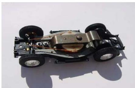
*A gauche le châssis vibreur modèle 1962 à cloquage, plus besoin de dévisser pour changer l'essieu arrière, il s'emboîte, particularité de l'essieu il est sans palier. Ce châssis existera aussi en motorisation "compétition" voir ci-dessous à partir de 1970*
